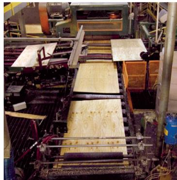
Varias capas delgadas de madera, o chapas, se laminan en conjunto bajo calor y presión para producir madera contrachapada.
