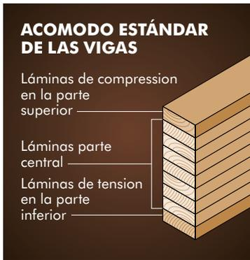
Las láminas de madera se unen entre sí con adhesivos resistentes a la humedad para producir elementos laminados.
