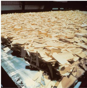
El OSB se produce con virutas de madera de forma rectangular que se conforman en un colchón.
