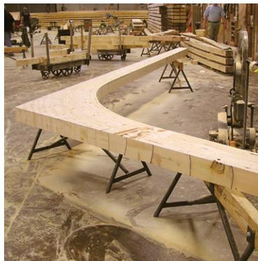
Las vigas laminadas, que pueden ser fabricadas en virtualmente cualquier tamaño o forma, ofrecen ilimitada flexibilidad para el diseño.
