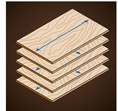
Alternando la dirección del hilo de las chapas entre capa y capa, es decir "orientando transversalmente," se maximiza la resistencia y rigidez del panel en ambas direcciones.
